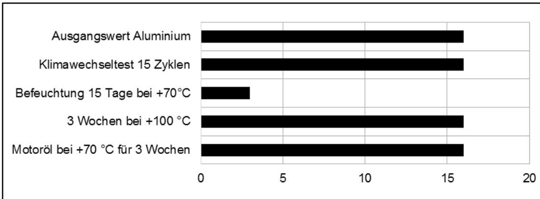
Vorbehandlung: Prüfkörper Aluminium 2017A gereinigt und geätzt. Aushärtung bei Raumtemperatur
