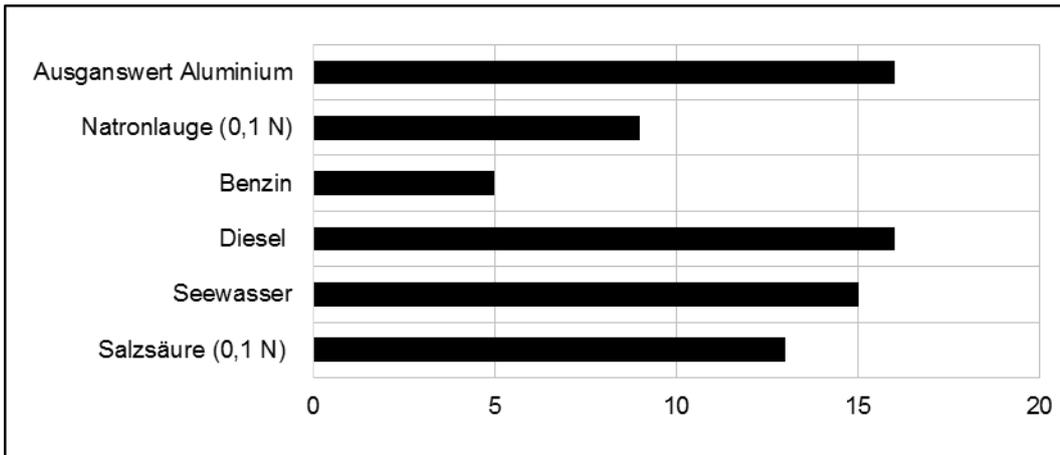
Vorbehandlung: Prüfkörper Aluminium 2017A gereinigt und geätzt. Aushärtung und Prüfung bei Raumtemperatur
