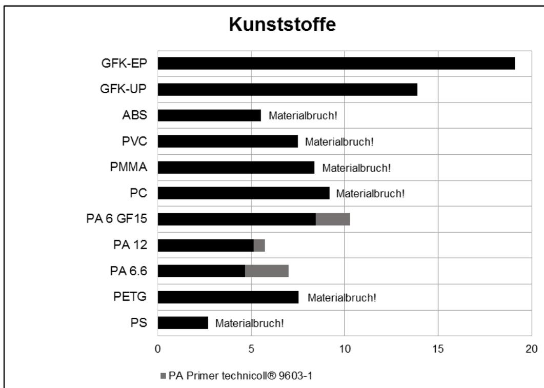
Vorbehandlung: Prüfkörper gereinigt, Metalle sandgestrahlt. Kunststoffe und verzinkte Metalle leicht angeraut. Prüfung bei Raumtemperatur.
